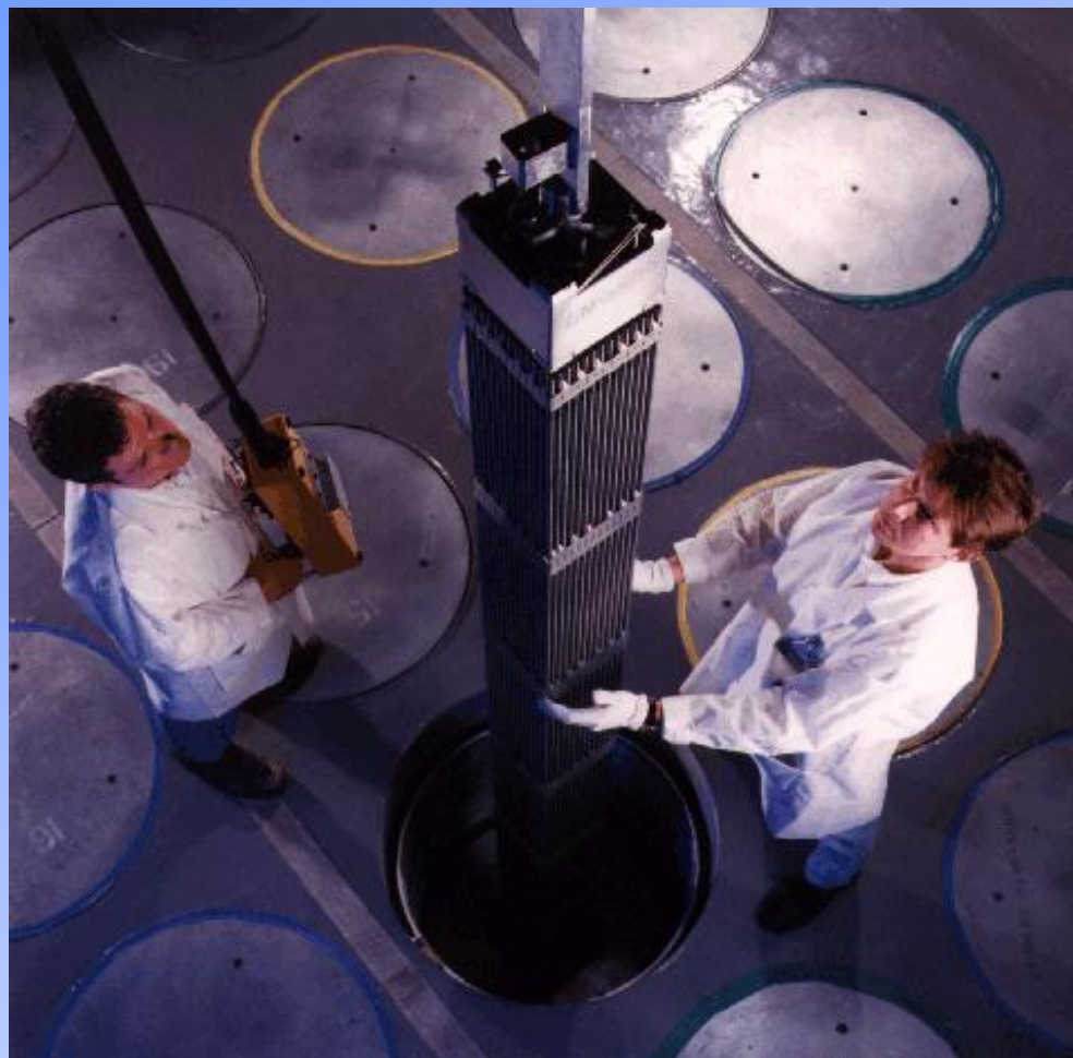
Zestaw paliwowy MOX – z mieszaniny tlenków uranu i plutonu
