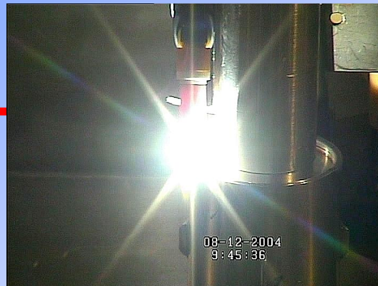
Spawanie kapsuły wypełnionej helem
