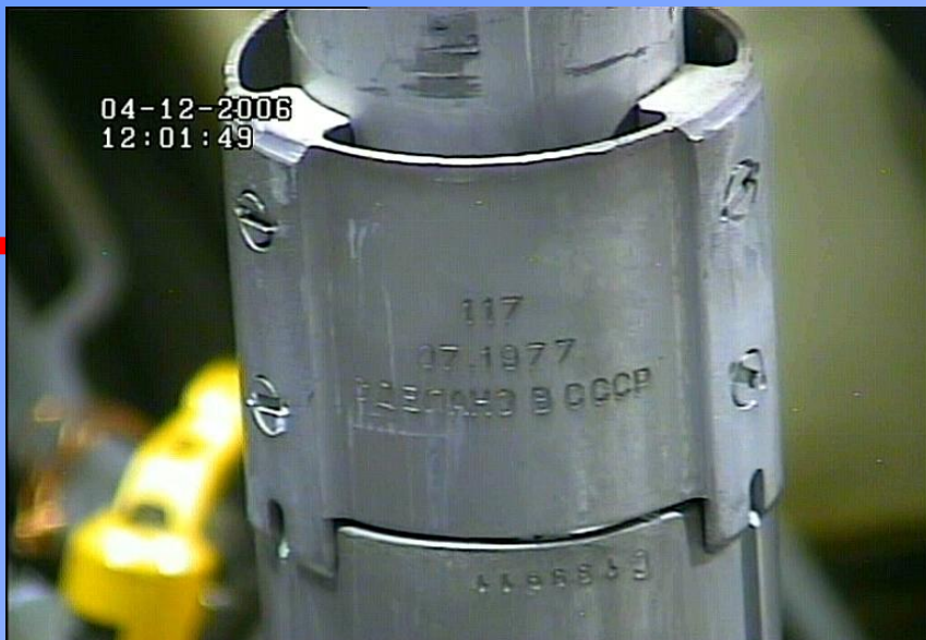
Zestaw paliwowy wkładany do kapsuły
